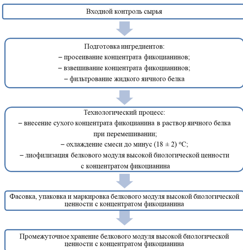
Рис. 1. Схема технологического процесса получения белкового модуля высокой биологической ценности с концентратом фикоцианинов
