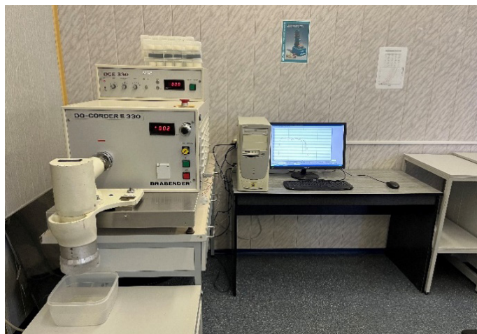
Рис. 1. Информационно-измерительная система для определения твердозерности зерна пшеницы на базе прибора «Do-corder E330»
