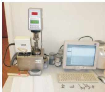
Рис. 1. Схема экспериментальной установки для исследования процесса перемешивания пищевых продуктов:
